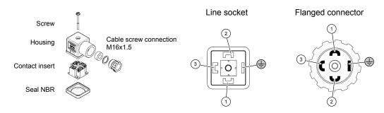
Fig. 12: Line socket DIN EN 175 301-803-A
