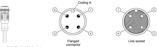
Fig. 13: M12 plug DIN EN 61076-2-101
