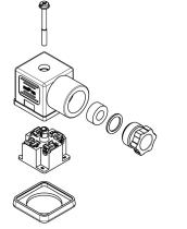
Fig. 18: Line socket DIN EN 175 301-803A
